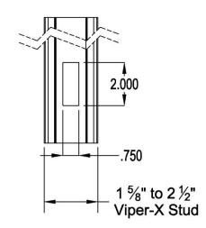
**FIGURE 3- PUNCH-OUT CONFIGURATION**
